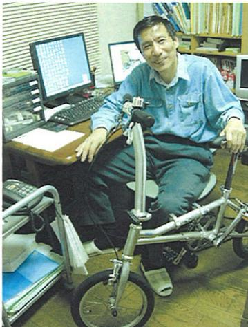
折り畳み自転車の命題である軽量化と強度をYS-11の構造を参考に実現した。YS-11では、強度が求められる主翼とエンジンの接合部分の骨組みに「三角フレーム構造」が多用されている。その軽量で最も強度ある形がこの自転車には活かされている。「本当は、この自転車もボケットに入るくらいのものなら良いよね。使う人が楽でしょう」。
