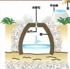
▲土中に埋めた瓶に水がしたたり落ちて反響することにより、琴のような美しい音色を生じさせる仕組みになっています。
