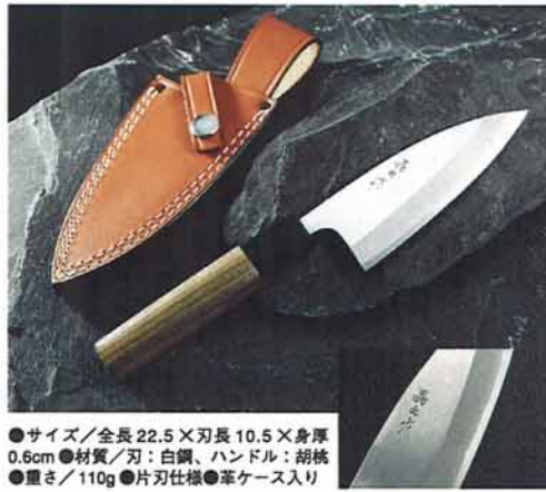
釣り愛好家、海洋学者に人気の商品。プロ用包丁である小出刃は、片刃構造で切れ味抜群。小魚〜中型の魚の調理向き。柄は胡桃を使用しています。 ●サイズ/全長22.5×刃長10.5×身厚0.6cm ●材質/刃：白鋼、ハンドル：胡桃 ●重さ/110g ●片刃仕様 ●革ケース入り
