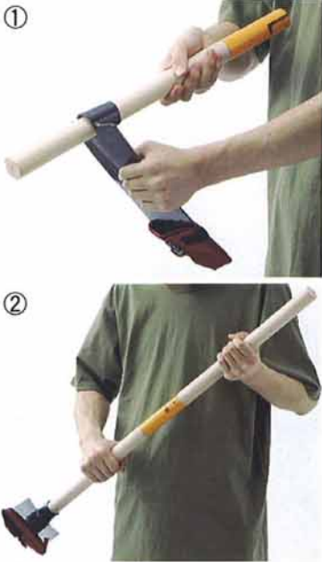
▲組み立ては、①刃に柄の上部をきっちりとはめて、②柄の上部に下部を差して回して止める2段階でOK。
